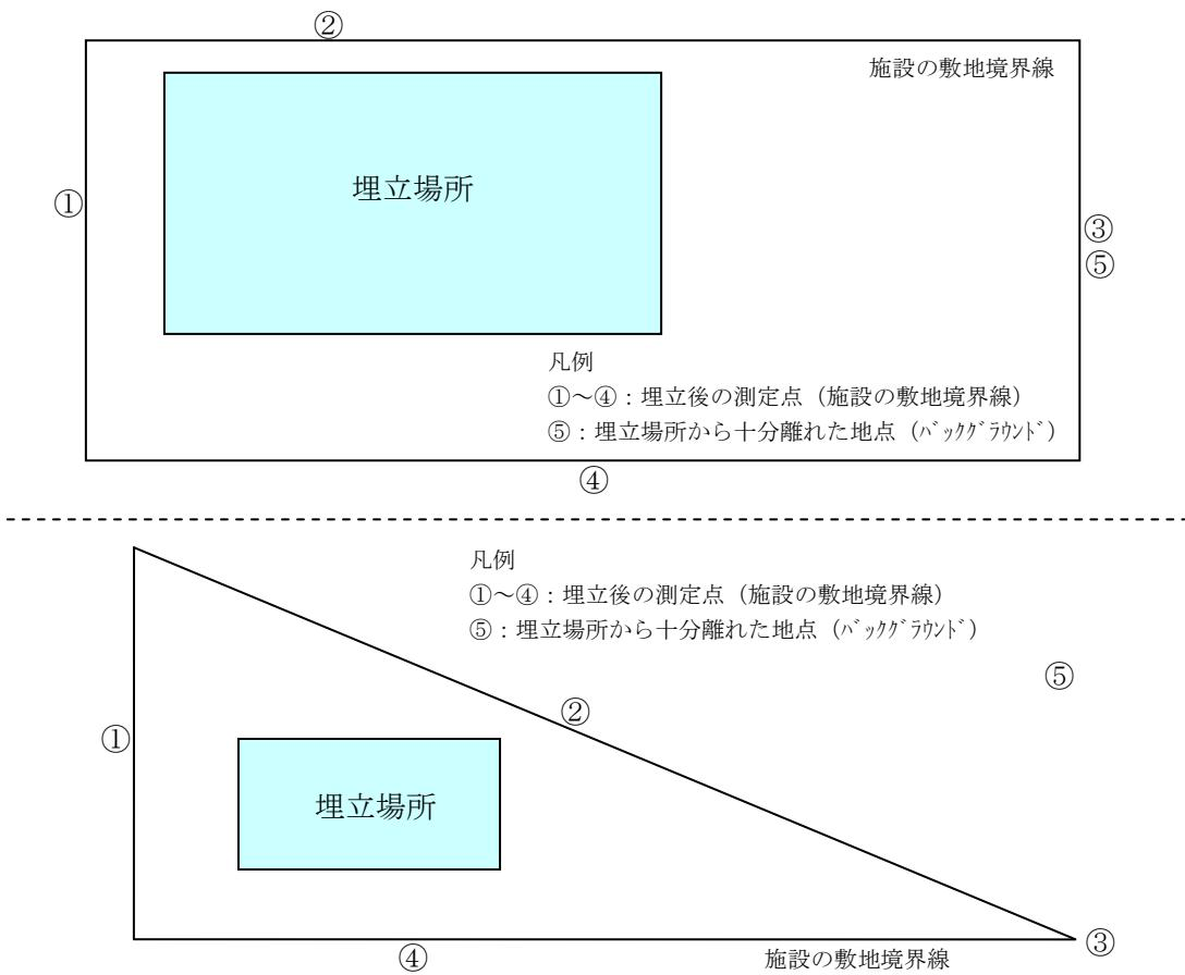
図2-8 埋立を開始後の測定地点の例
