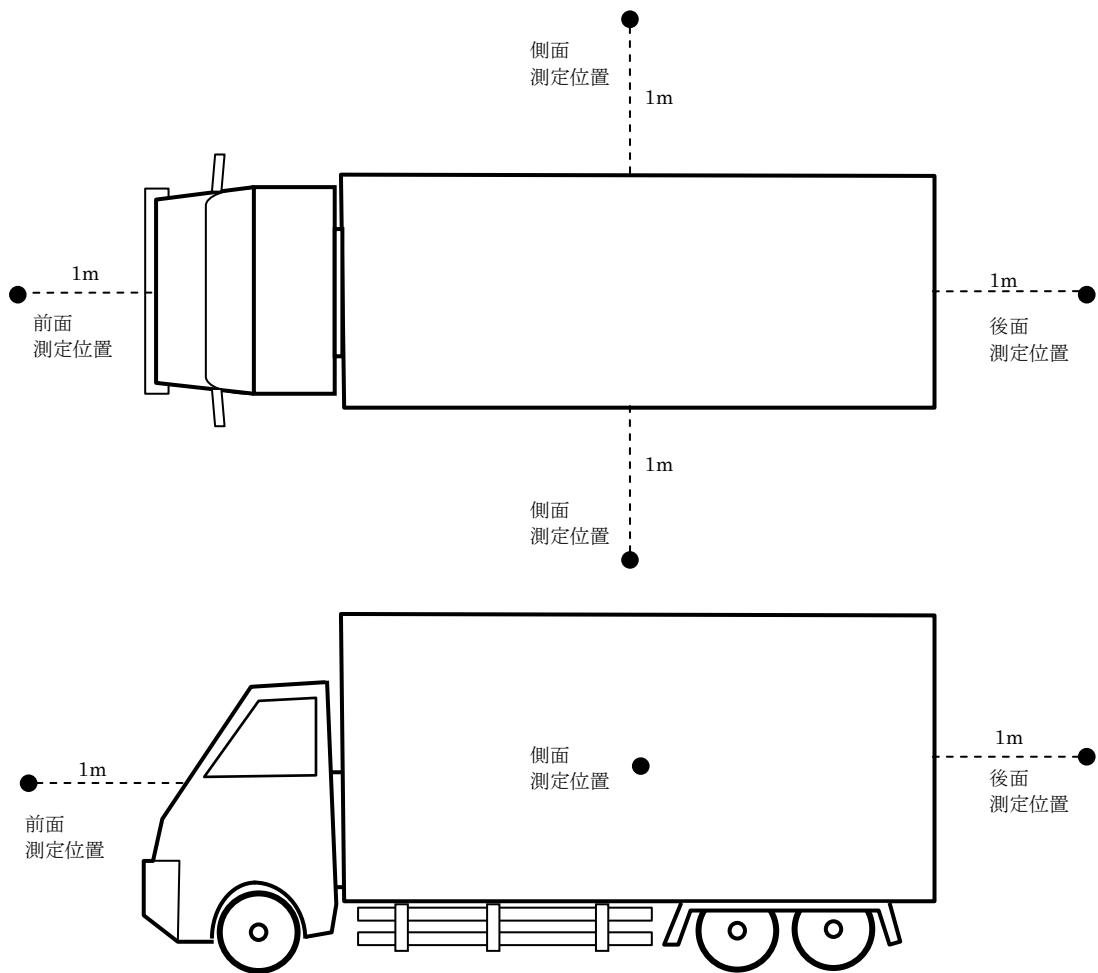
※測定は各面でスクリーニングを行い、最も空間線量率が高い箇所で行う。空間線量率の高い箇所が不明な場合は各面の中央で測定を行う。
