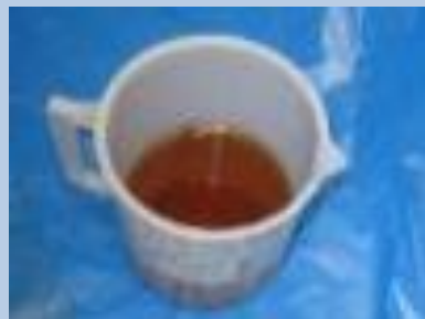
廃電気機器由来の 絶縁油（廃油）
