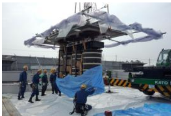
コアが上蓋に取り付けられたもの (養生された床面上に吊り下げ)
