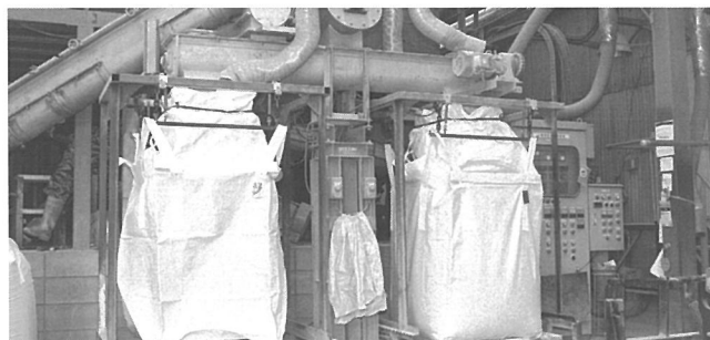
固化材のトンバッグ詰め
