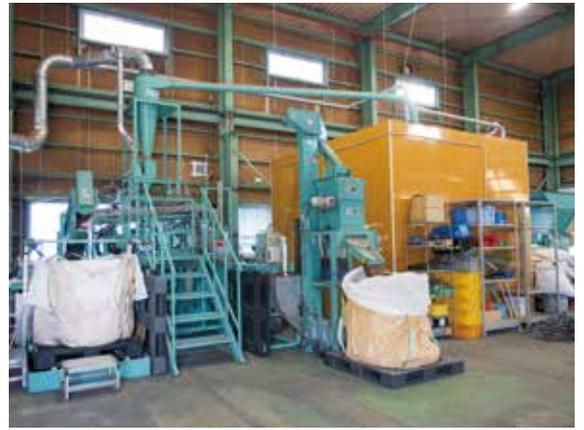
破碎、粉碎、選別、乾燥の4ユニットで構成される「廃電線処理プラント」
