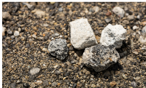
リサイクルプラントで破砕処理され、「RC-40」として生まれ変わる
