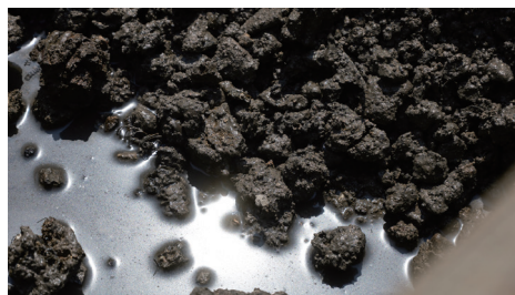
焼却処分で発生した残渣。このあと溶融などの工程を経て再資源化される
