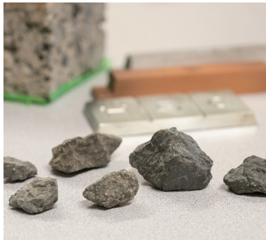
焼却灰を溶融し再生骨材として活用したサンプル。資源循環の実践例
