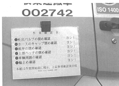
作業中は車両のドアに「作業確認表」を貼る。
