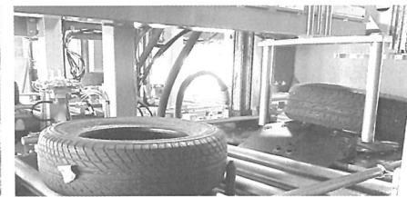
⑤ビードワイヤーを引き抜かれたタイヤは、排出口に押し出され、次のタイヤが準備される。
