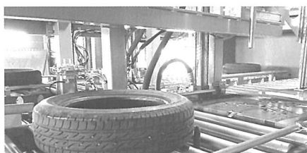
①回転するローラーの上をタイヤが移動する。
