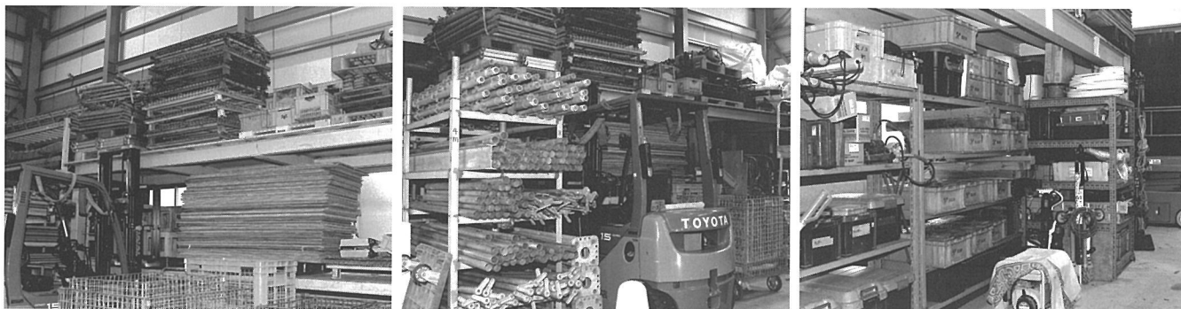
作業場にある資材は、使用目的ごと、形状や大きさごとに分けて並べ、使用後は点検（使用による劣化、破損等）して元の位置に戻しています。
