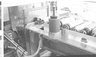
同社製作のスプレー缶自動分解処理機
