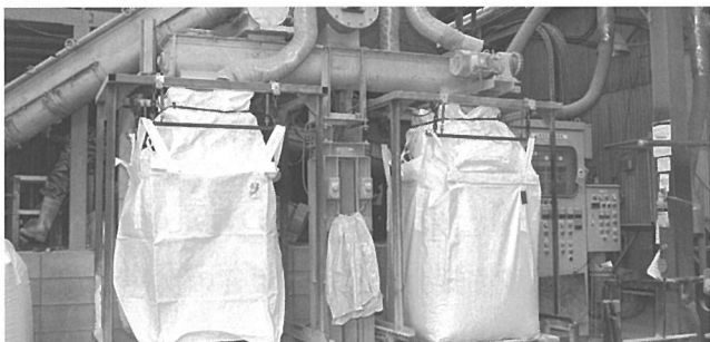
固化材のトンバッグ詰め
