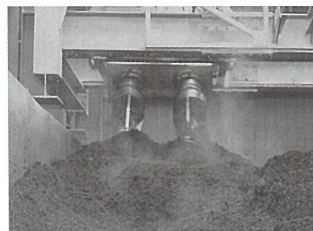
温風を出しながら2軸のスクリューで攪拌
