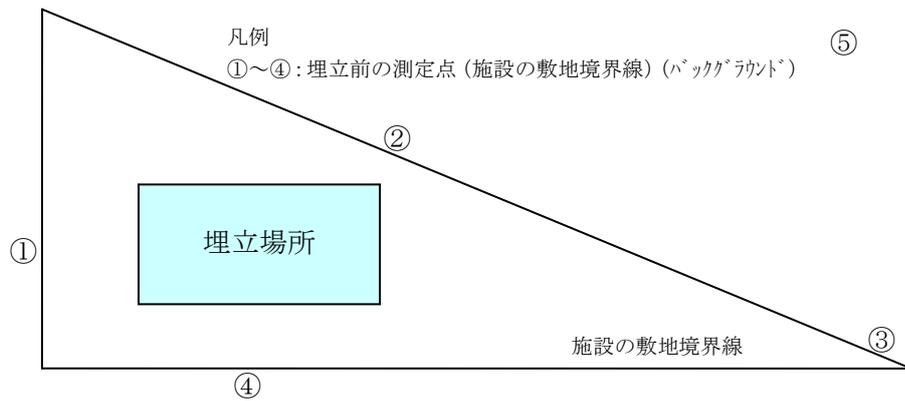
図2-7 埋立を開始する前の測定地点の例
