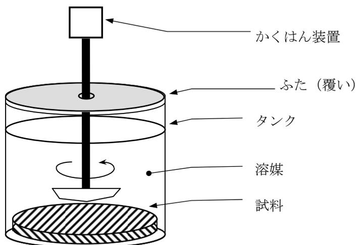
図 8-1 溶出量試験装置の概要図
