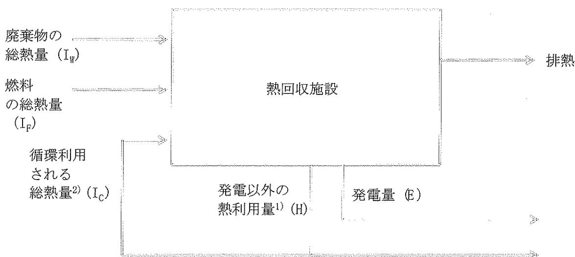
$$\text{熱回収率}(A)[\%] = \frac{\text{発電量}(E)[MWh] \times 3600 + \text{発電以外の熱利用量}(H)[MJ] - \text{燃料の利用に伴い得られる熱量}(F)[MJ]}{\text{投入エネルギー量}(I)[MJ]} \times 100$$
